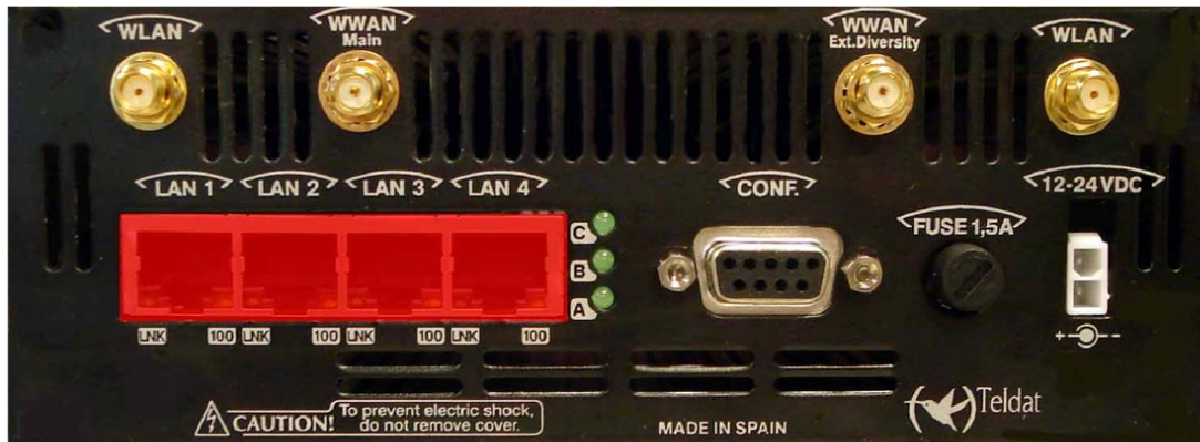
Fig. 4: LAN Switch ports (4)
